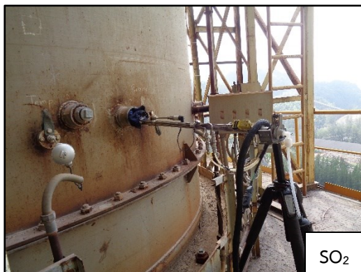
ภาพที่ 3.4 การตรวจวัดคุณภาพอากาศจากปล่องหม้อเผา 6
